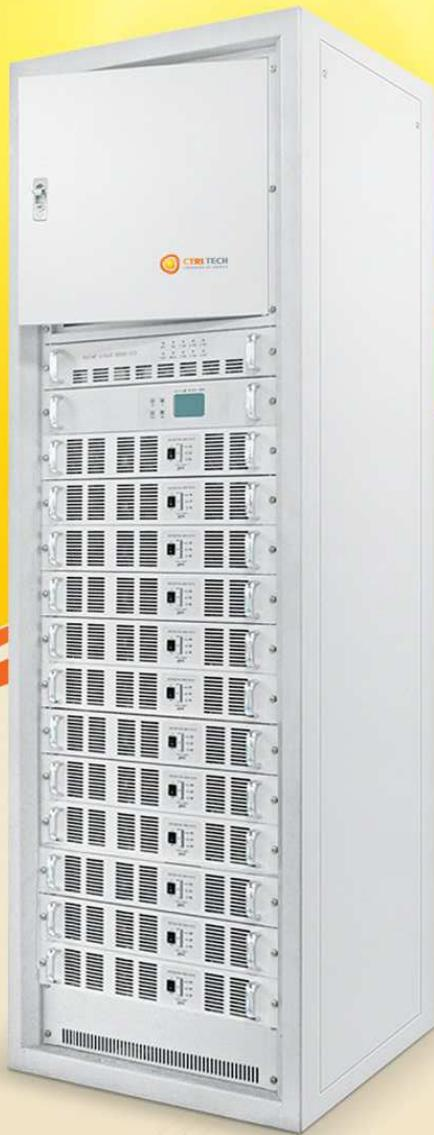
O sistema de potência de inversores paralelos CPCS 01 é formado por módulos inversores paralelos CPCI 01, pelo módulo de monitoramento CPCK, pelo módulo da chave estática CSTS e pelo PDU CC e CA.
